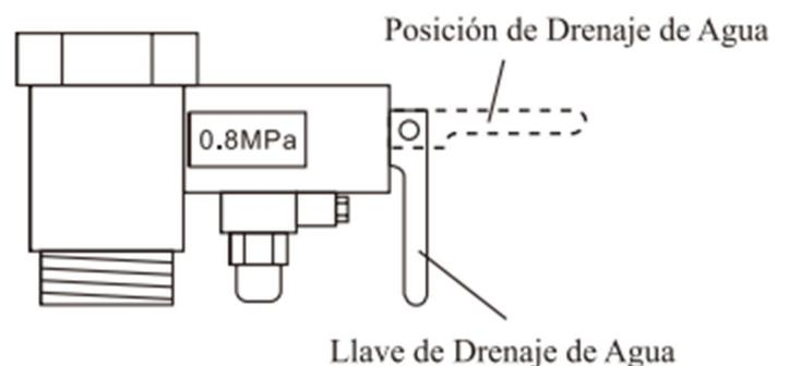
Se sugiere instalar un conducto de evacuación de agua desde la válvula de seguridad a un desagüe, ya que la válvula de seguridad puede abrir debido a altas presiones o temperaturas, eliminando agua. Nunca bloquee o deshabilite la válvula de seguridad, ya que es un elemento necesario para el funcionamiento seguro del artefacto.
