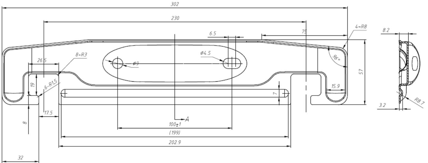
El anclaje del termo de 150 lts requiere una separación de 20 cm según se muestra en el detalle a continuación:
